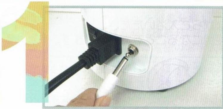
① 本体裏側に、電源コードと電極ジャックを差し込みます。
